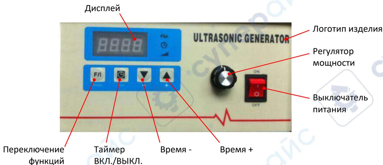
**Переключение функций (F/I):** зажмите кнопку для переключения между настройками тока/частота/ режима работа.
