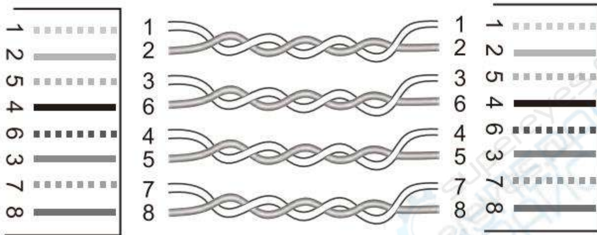
Схема подключения раздельной пары
