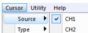
Пользователь может выбрать в качестве источника каналы **CH1**, **CH2**.
