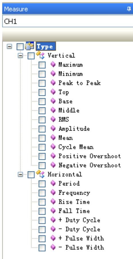
Для измерения частоты и  $V_{pp}$  (размаха сигнала напряжения) выполните следующие действия:
