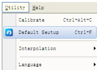
После нажатия на эту кнопку осциллограф отображает сигналы каналов 1 и 2 и убирает все остальные сигналы.
