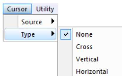
Имеется три вида курсорных измерений: **Cross** (точечный), **Vertical** (вертикальный) и **Horizontal** (горизонтальный).
