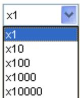
**Примечание:** Коэффициент деления изменяет пропорциональное уменьшение размеров по вертикали осциллографа так, чтобы результаты измерений отражали уровни фактического напряжения на щупе.
