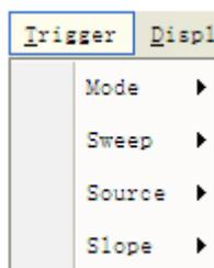
Синхронизация обозначает тот момент, когда осциллограф запускается для получения данных и отображения сигнала. Когда запуск настроен правильно, он может преобразовывать нестабильные изображения или пустой экран в отчетливый сигнал.
