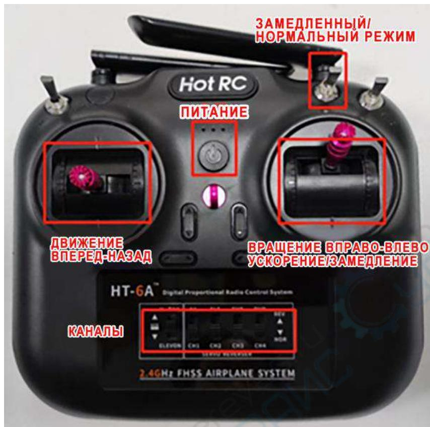
Рисунок 1-5-1 Пульт-контроллер радиоуправления
