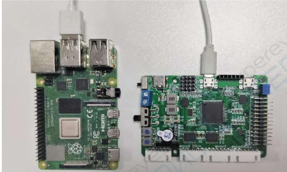
Рисунок 5-1-2 Подключение Raspberry Pi к контроллеру STM32
