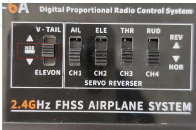
Рисунок 1-5-2 Каналы контроллера радиоуправления
