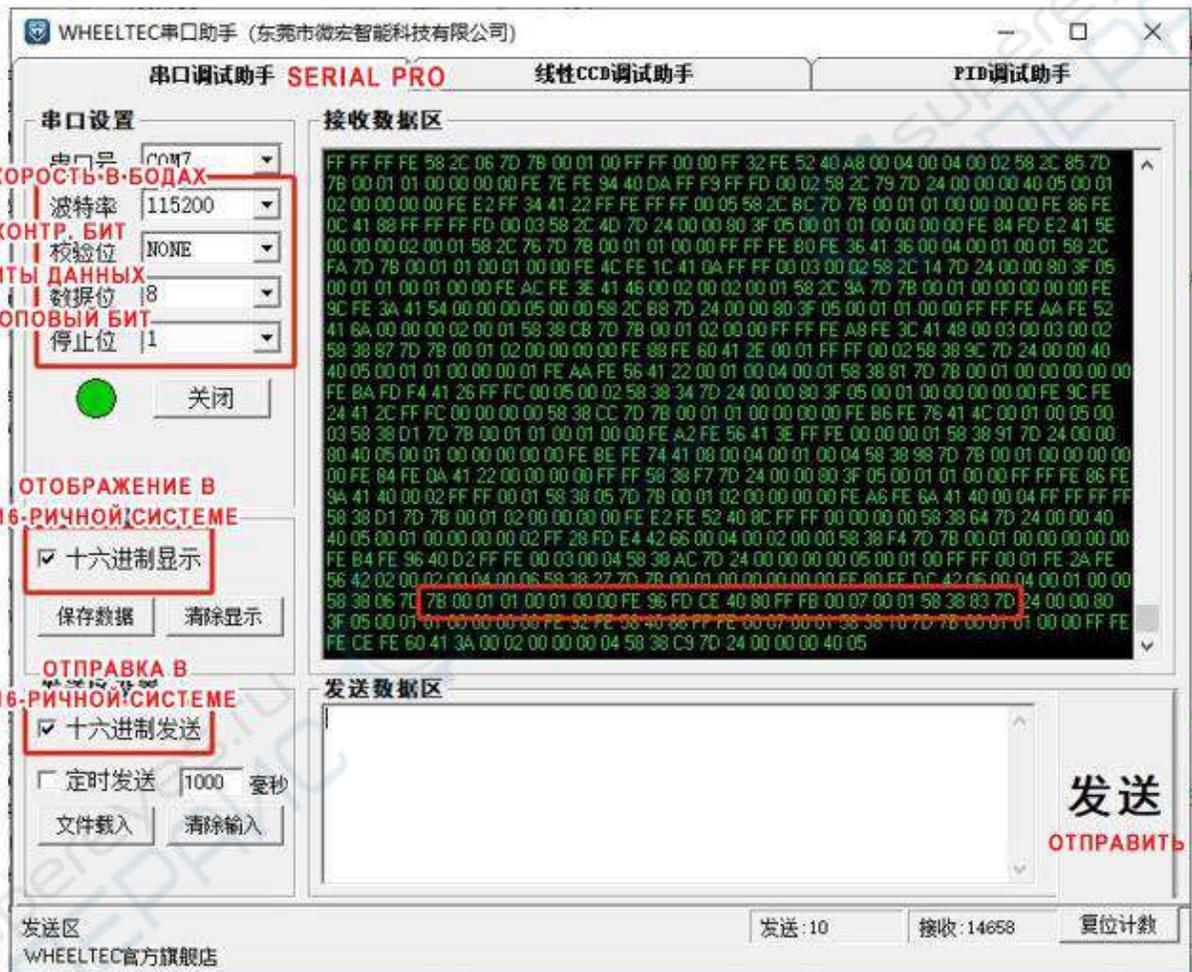
Рисунок 1-2-7 Отправка данных с последовательного порта 3 робота
