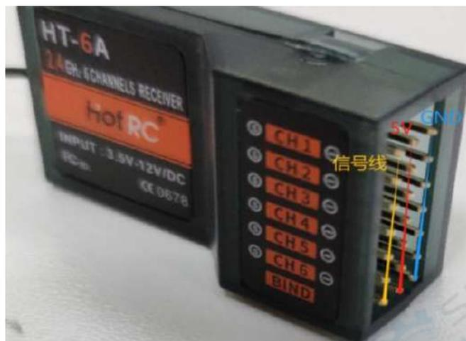
Рисунок 1-5-3 Приемник дистанционного управления
