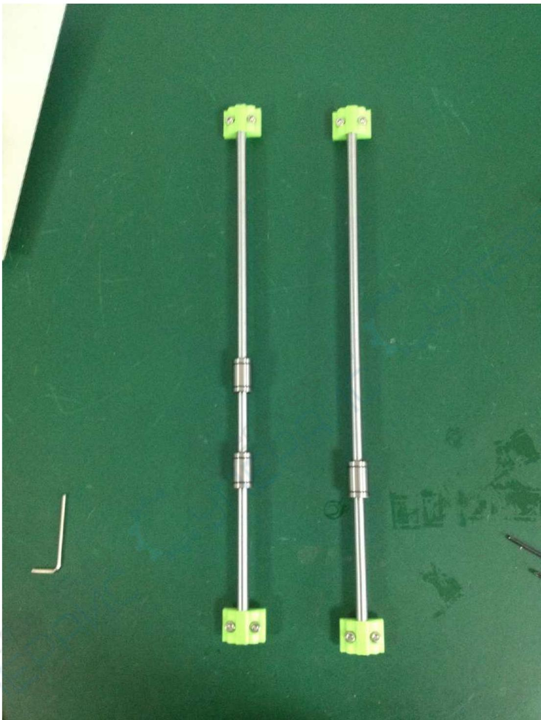
4. Прикрепите собранную конструкцию к каркасу. Обратите внимание на расстояния, указанные на рисунках ниже: расстояния от левого края профиля до крепления 60 мм, расстояние между двумя осями – 140 мм.
