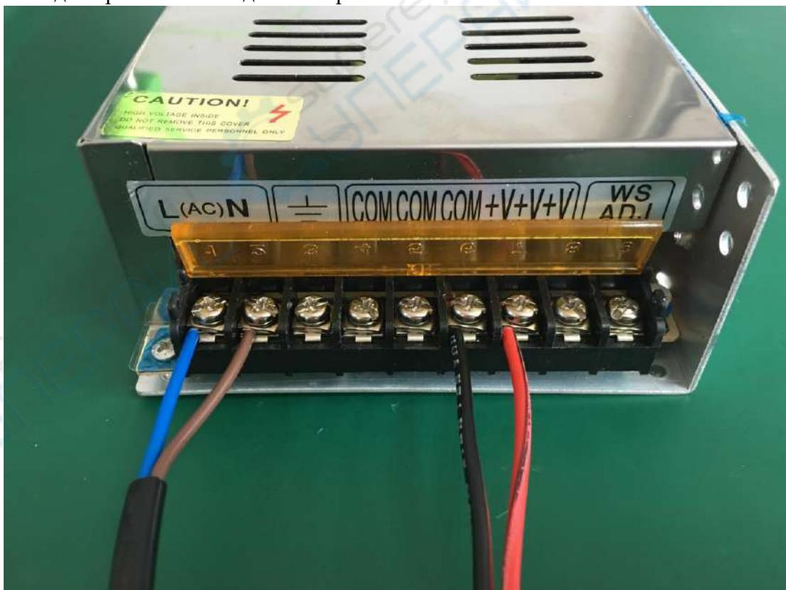
Подключение кабелей входного напряжения 220 В и выходного 12 В.
