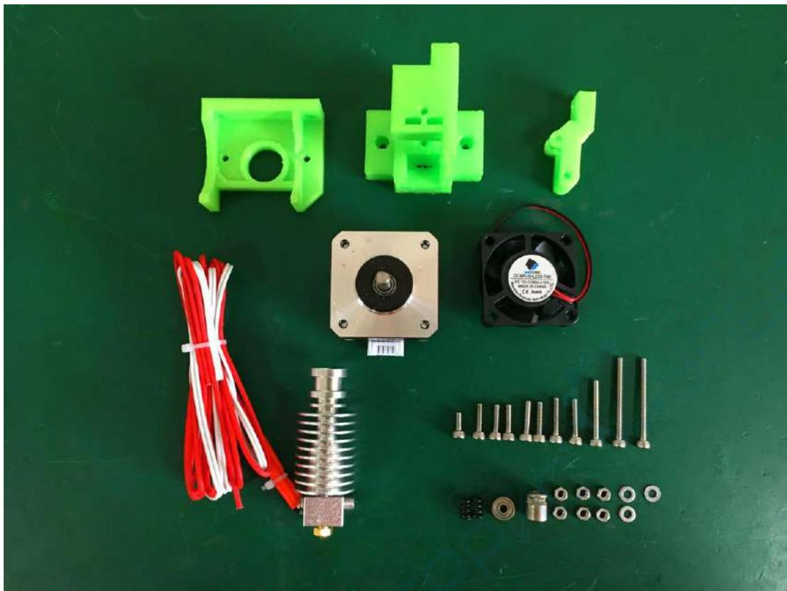
Детали: печатные детали (3 шт.), сопло (1 шт.), двигатель (1 шт.), кулер (1 шт.), короткая пружина (2 шт.), малый подшипник (1 шт.), экструзионная передача (1 шт.), гайка М3 (6 шт.), шайбы М3 (3 шт.). Винты и гайки: М3\*8 (1 шт.) М3\*12 (3 шт.), М3\*14 мм (2 шт.), М3\*16 (2 шт.), М3\*25 (1 шт.), М3\*35 (2 шт.).
