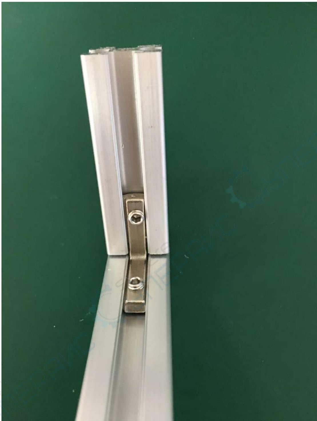
**9. Способ соединения профилей L-образным уголком (для сборки принтера обновленной версии).**
