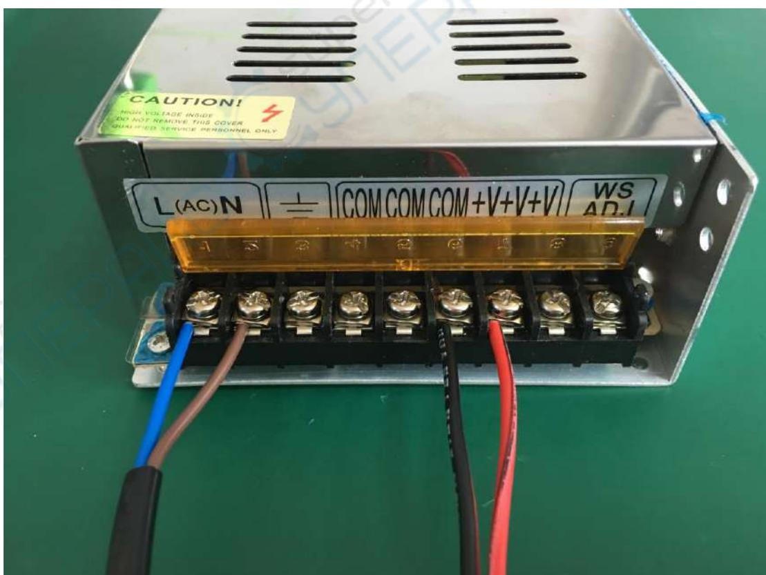
7. Подключение кабелей входного напряжения 220 В и выходного 12 В.
