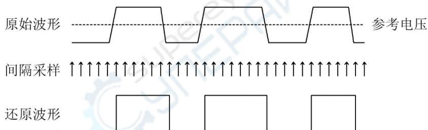
根据硬件设计上的差异，逻辑分析仪大致可分为独立式（或称单机型）或需结合电脑使用的虚拟式。芯驿电子科技（上海）有限公司推出的逻辑分析仪产品均属于虚拟式逻辑分析仪。设备硬件根据设定的条件采集被测信号，然后将采样数据上传到电脑端的软件 Play Logic。软件将采集到的原始数据还原为数字波形显示到电脑屏幕上，并可以根据所支持的标准协议对数据进行解码，以及其他一些分析及测量功能。
