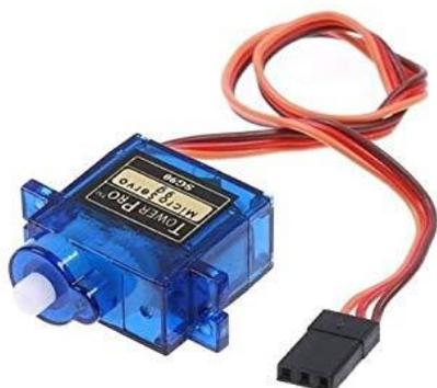
Сервомотор - это DC мотор с примочками. К обычному мотору прикреплен микросхема с потенциометром. Такая обвязка позволяет контролировать угол поворота мотора. Сервомотору можно дать команду встать в любой угол из возможного интервала. У наших сервомоторов интервал от 0 до 180 градусов.
