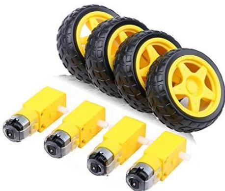
Мотор постоянного тока (DC мотор) - знакомый всем моторчик из игрушек. На клеммы подаётся напряжение - вал крутится. Разные уровни напряжения - разная скорость. У наших моторов есть понижающий редуктор. Редуктор - это набор шестерёнок, который преобразует мощность мотора в полезную работу. Для применения в качестве моторов для колёс количество оборотов в минуту у наших моторов очень
