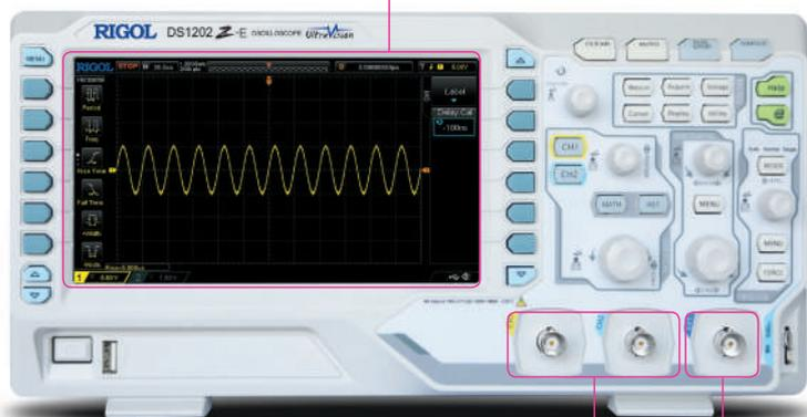
2个模拟通道 外触发输入通道
