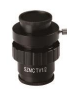
SZM 1/2x CTV CCD Port:1" x1/32" Trinocular Port:M28x0.75
