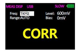
2. Нажмите кнопку «▲ NULL» для калибровки разомкнутой (OPEN) или замкнутой (SHORT) цепи (пример на рисунке ниже). Если калибровка проходит успешно, на экране отображается сообщение «SUCESS»; в противном случае, отображается сообщение «FAILED».
