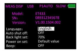
В окне системных настроек отображается информация о модели, серийном номере и версии многофункционального тестера. Кроме того, в данном окне можно настроить язык интерфейса, функцию автоматического выключения устройства, яркость, параметры включения питания и звуковую индикацию.
