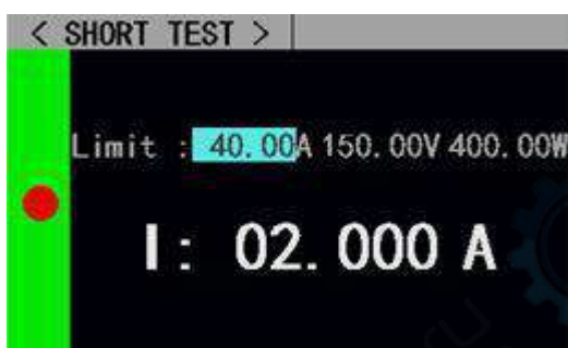
Рисунок 7.10. Тест на короткое замыкание.
