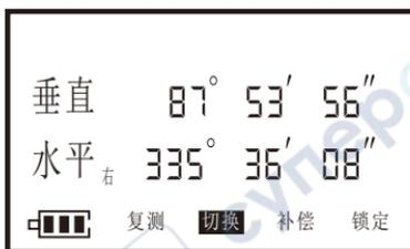
DT系列电子经纬仪液晶显示屏共现实三行内容;第一行为垂直度盘角度值;第二行为水平度盘角度值;第三行为电池容量和仪器状态。
