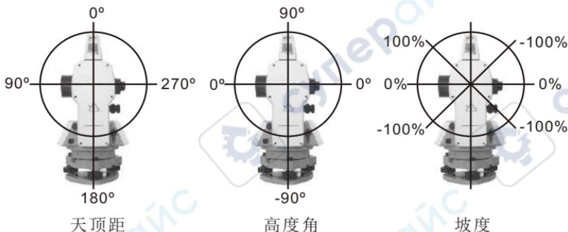
其中，高度角模式需要在仪器设置中进行设置，一般较常使用的为天顶距模式，其与坡度模式的切换在仪器正常界面下操作。
