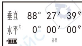
3) 参考7.1水平角度测量(顺时针)中步骤2至5, 读出两点间的水平夹角的值。
