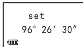
5) 按[左=右]键, 仪器保存校正新值并退出指标差校正界面回到仪器正常测量界面。
