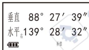
2) 按[切换]键然后再按[锁定]键进入水平角复测界面, 显示屏下方会显示“复测”字样;
