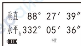
2) 按[锁定]键,仪器下方显示“锁定”字样,表明仪器水平角度值处于锁定状态,此时转动仪器水平角度值不变,且其余所有会对仪器角度值产生影响的按键失效;
