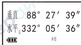
2) 按[左=右]键使水平角度显示模式切换为水平左模式;
