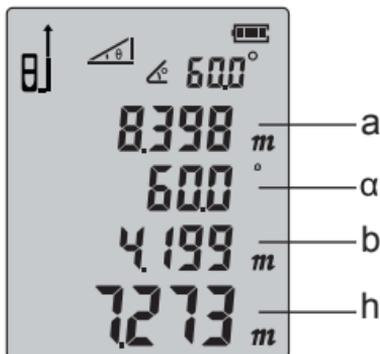
2) 测量直角三角形两直角边，间接测量斜边长度
