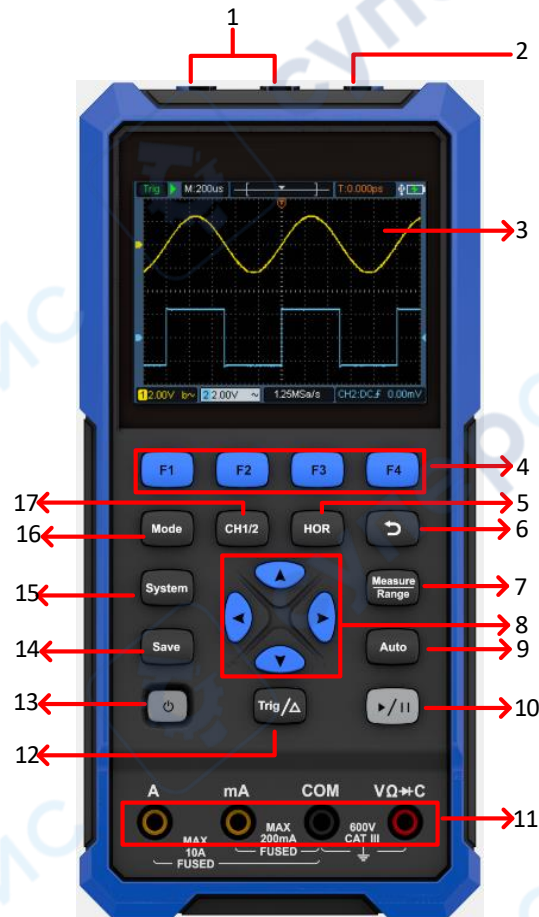
Рис.1: Передняя панель осциллографа
