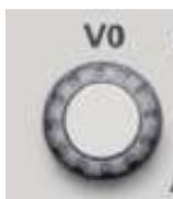
V0: универсальный регулятор. В различных меню используется для выбора параметров (MEASURE), перемещения курсоров и уровней (Slope Trigger). Нажмите на регулятор для сброса настроек (задержка триггера, компенсация триггера, фронт триггера), выбора пунктов меню и пр. Прост в эксплуатации.
