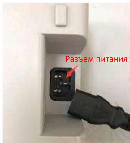
Осциллограф работает от сети переменного тока 100-240 В, 45-440 Гц. Для подключения осциллографа к электросети используйте кабель питания из комплекта поставки.
