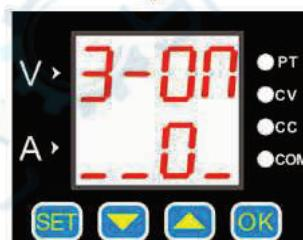
Нажмите **SET** для перехода в режим настройки активации выхода устройства при включении питания. Кнопками **▲** и **▼** выберите нужную опцию: 0 – выкл., 1 – вкл. Подтвердите выбор кнопкой **OK**.
