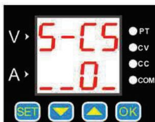
Нажмите **SET** для настройки протокола связи. Кнопками **▲** и **▼** выберите нужную опцию: 0 – обычное подключение, 1 – протокол MODBUS RTU. Подтвердите выбор кнопкой **OK**.
