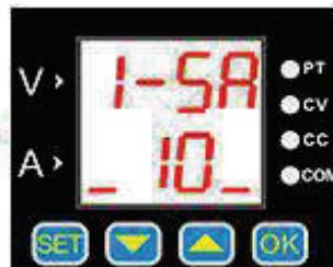
Зажмите кнопку **SET** для перехода в режим настройки макс/мин значений тока и напряжения. Кнопками **▲** и **▼** установите нужное значение, 10 – макс. значение, 11 – мин. значение, 12 – отмена. Нажмите кнопку **OK** для подтверждения.
