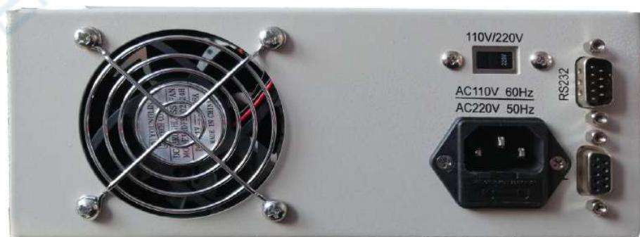
图 6.2.1 模拟电池后面板
