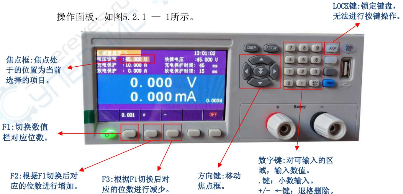
图5.2.1 — 1 电压设定
