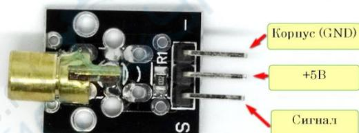
Рис. 3 Цоколевка блока лазера
