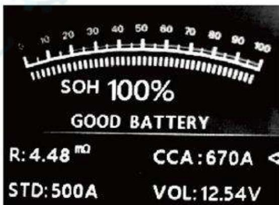
Аккумулятор в хорошем состоянии и полностью готов к эксплуатации.
