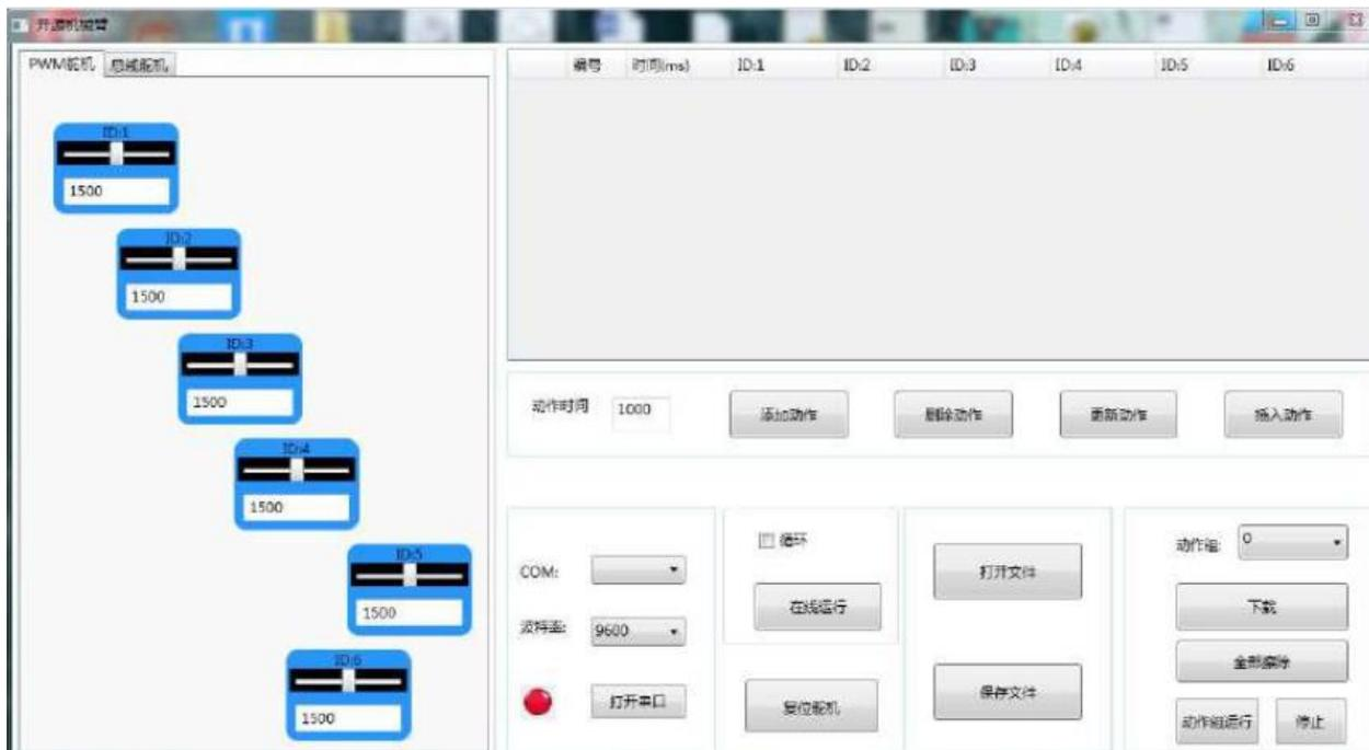
На скриншоте показано только то, на что преимущественно следует обратить внимание. Во-первых, в левом верхнем углу находятся две вкладки: ШИМ-сервоприводы и сервоприводы общей шины. На панели расширения LeArm есть порты для подключения сервоприводов общей шины. При покупке шины для сервоприводов нашего производства, вы можете переключиться на вторую вкладку и управлять роботом по общей шине.
