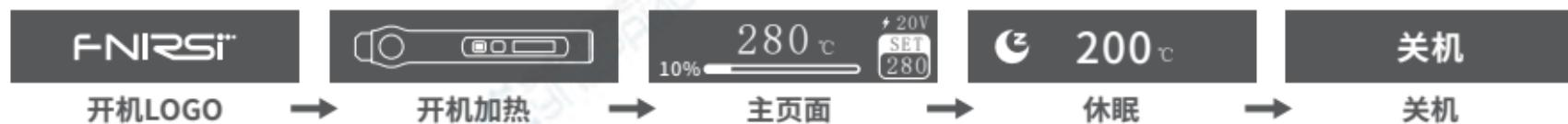
HS-01智能烙铁工作流程如上图所示，上电后显示logo，短按一次对应闪烁的实体按键进行加热，当童锁模式开启时短按三下对应的实体按键进行加热。进入主界面，烙铁处于正常工作状态，分为以下三种：
