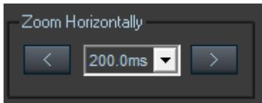
Если сбор данных формы сигнала остановлен управление параметром Время/Деление (**Time/Div**) растягивает или сжимает форму волны сигнала по горизонтали.
