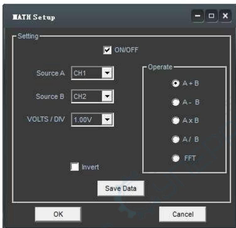
**ON/OFF** (Вкл/Выкл): Включает или выключает канал результата математических операций.
