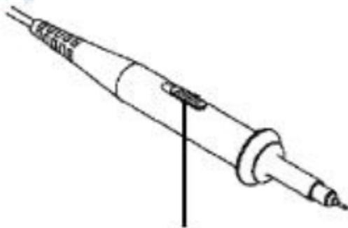
Рисунок 8 — Переключатель коэффициента ослабления на щупе
