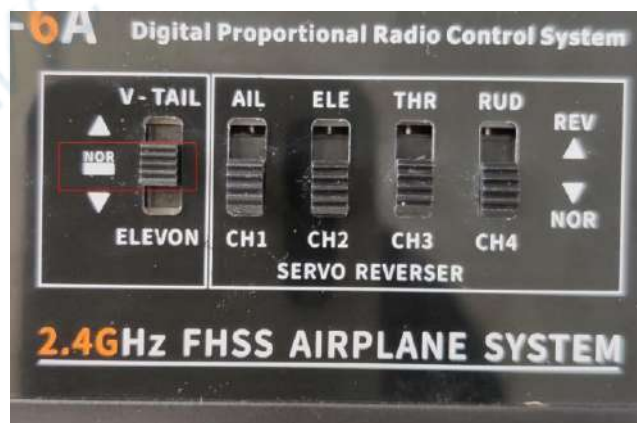
Рисунок 1-5-2 Каналы контроллера радиоуправления
