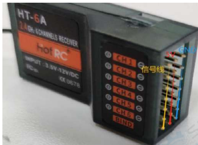
Рисунок 1-5-3 Приемник дистанционного управления
