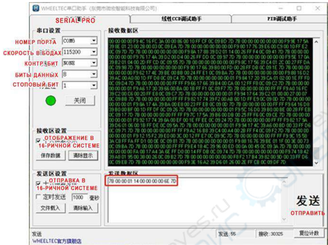
Рисунок 1-7-2 Отправка данных на последовательный порт через Serial Pro
