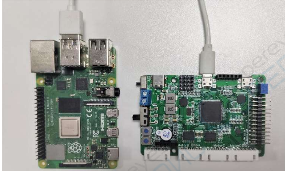
Рисунок 5-1-2 Подключение Raspberry Pi к контроллеру STM32
