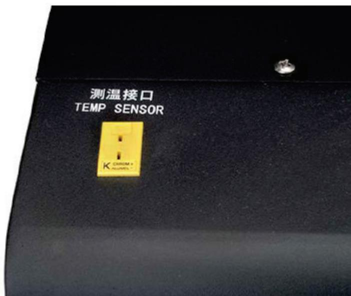
8. В устройстве используется высокотехнологичная система контроля температуры с обратной связью, система автоматической регулировки температуры с ПЛК и модуль точного контроля температуры  $\pm 2^{\circ}\text{C}$ . Внешний датчик температуры используется для контроля температуры и точного анализа температурного профиля в режиме реального времени.
