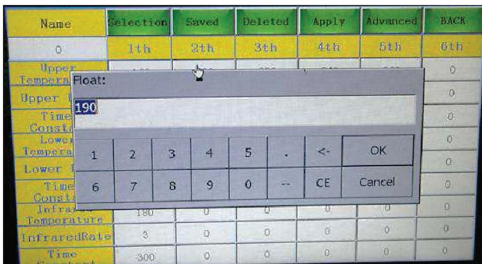
При сохранении профиля можно нажать на кнопку **Name**, ввести имя профиля и нажать кнопку **OK** для сохранения профиля. Кроме того, можно выбрать существующий профиль кнопкой **Curve Selection** для его перезаписи.
