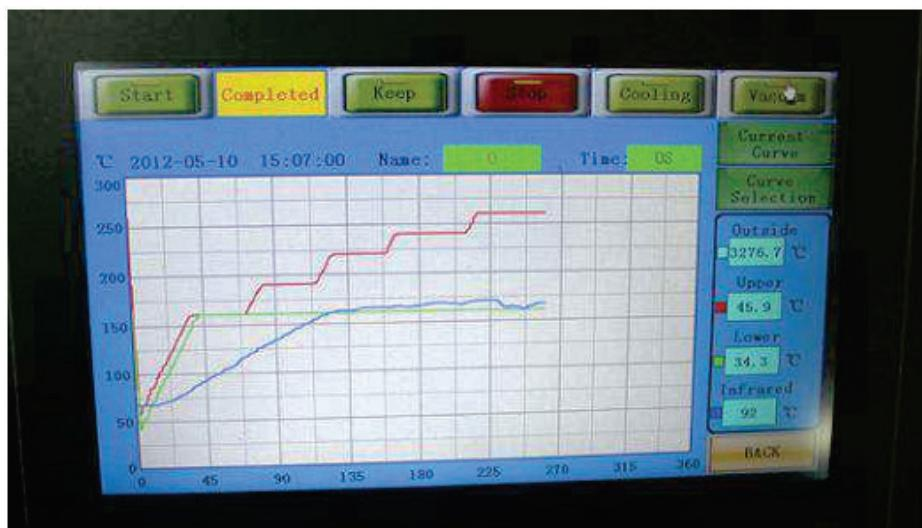
7. При необходимости пользователи могут сохранять собственные профили (Saved) для их последующего использования. Использование сохраненных профилей позволяет значительно сэкономить время при эксплуатации паяльной станции.
