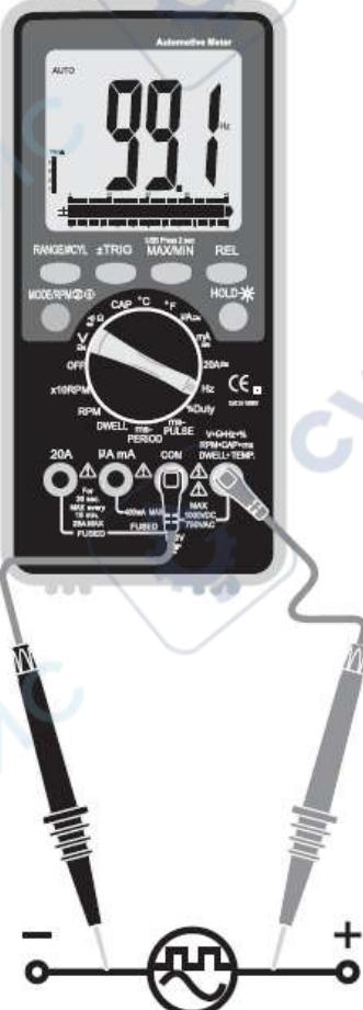
**4-8. Режим измерения – длительность замкнутого состояния прерывателя (  $\Delta^\circ$  )**
