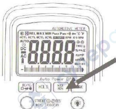
1. Нажать кнопку «MAX/MIN» для перехода в режим запоминания максимального и минимального значений параметра. На экране прибора отображается индикатор «MAX» или «MIN». Прибор переключается в режим ручного выбора диапазона значений и фиксирует максимальное или минимальное показание, которое обновляется в случае превышения предыдущего значения.
