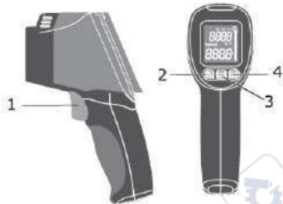
1 – рычаг измерения (прибор автоматически выключается примерно через 15 минут бездействия)
