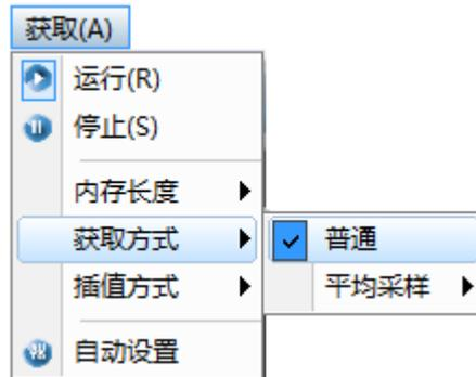
**普通：**采用此采样模式，示波器是以均匀的时间间隔采集信号来创建波形。
