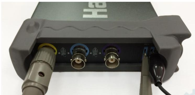
2. 将探头的滑动开关推到X10端，并且设置示波器软件探头衰减系数为X10。(默认值是X1)
