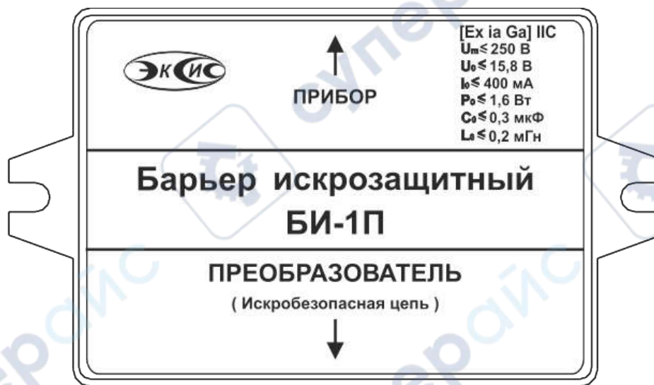
Рисунок 3.18 Барьер искрозащиты БИ-1П
