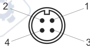
Рисунок 3.5 Разъем для подключения измерительного преобразователя
