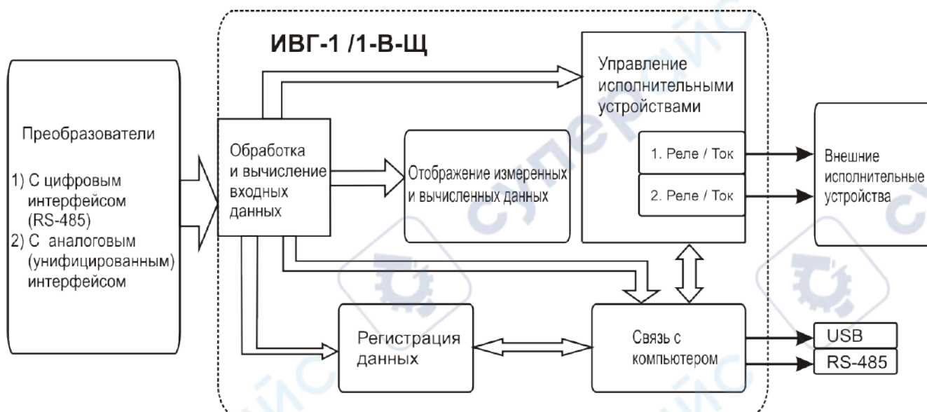
Рисунок 3.7 Структурная схема работы прибора
