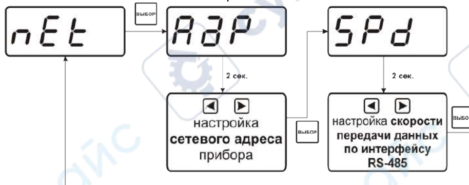
Рисунок 6.36 Меню установки параметров прибора для работы в сети
