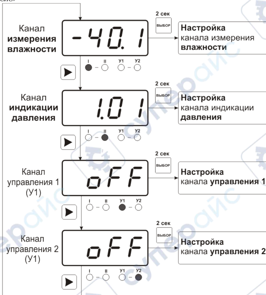
Рисунок 6.16 Схема режимов “РАБОТА” и “НАСТРОЙКА”
