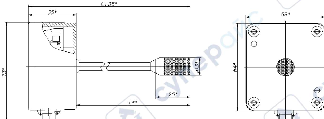
Рисунок В8 Измерительный преобразователь ИПВТ-03-14
