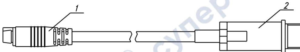
Рисунок 3.3 Кабель-удлинитель для измерительных преобразователей, приведенных в ПРИЛОЖЕНИИ В в пунктах 1, 4, 6, 7 ;
