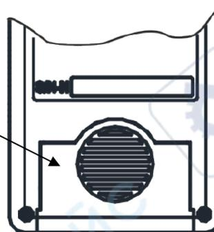
Емкость аккумуляторов составляет 1800 мА/ч, Зарядка осуществляется через разъем USB на боковой панели прибора. Для зарядки следует использовать зарядное устройство, обеспечивающее напряжение 5В с током зарядки не менее 1 А. Средний ресурс аккумулятора 500 циклов заряда-разряда.
