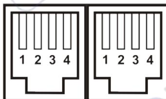
Рисунок 3.3 Цоколевка разъемов подключения к сети RS-485
