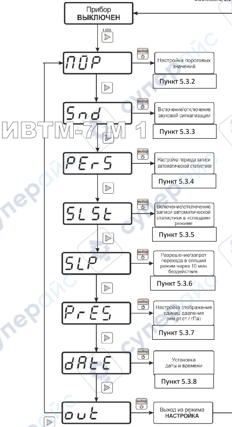
Рисунок 5.18 Схема режима НАСТРОЙКА ИВТМ-7 М 1
