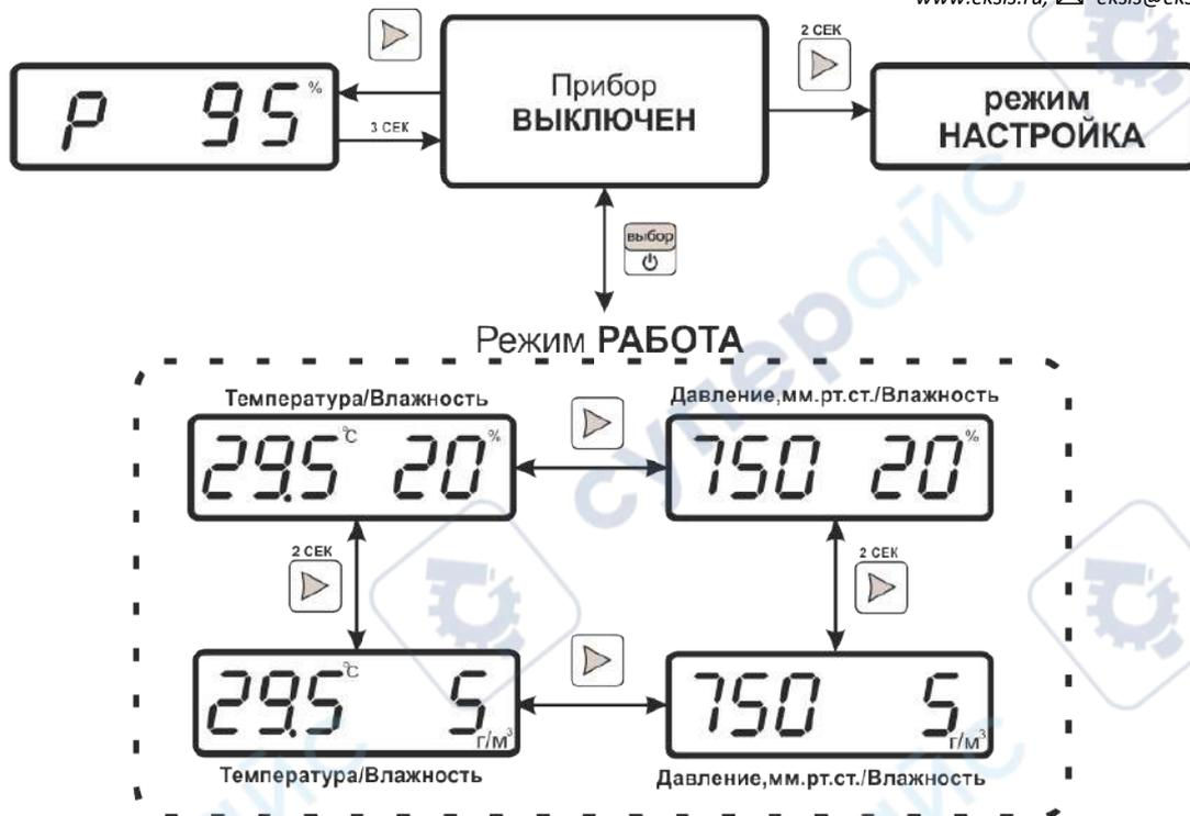
Рисунок 5.15 Режим РАБОТА ИВТМ-7 М 2(-Д), ИВТМ-7 М 3(-Д), ИВТМ-7 М 5(-Д), ИВТМ-7 М 7(-Д), ИВТМ-7 М К(-Д).
