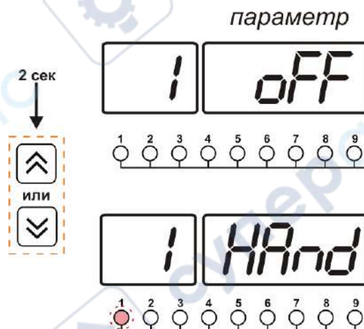
Рисунок 6.4 Ручное включение исполнительного устройства первого канала управления
