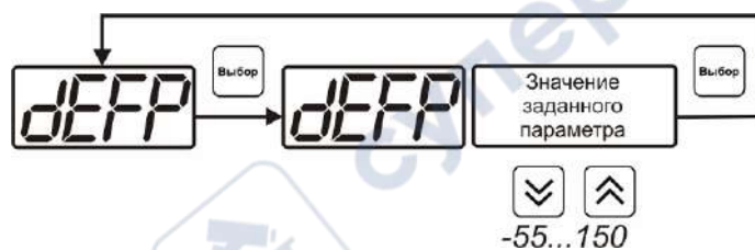
Рисунок 6.30 Введение постоянного параметра регулирования
