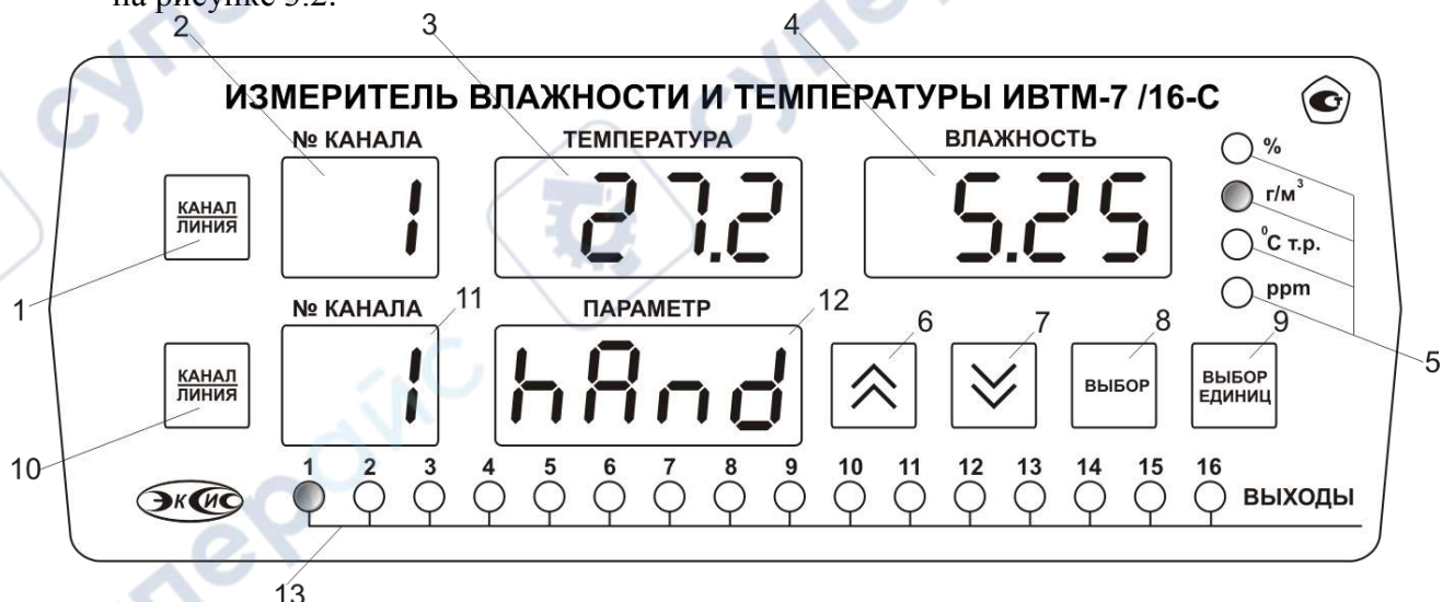
Рисунок 3.2 Вид лицевой панели прибора шестнадцатиканального исполнения
