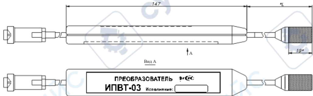
Рисунок В1 Измерительные преобразователи ИПВТ-03-01, ИПВТ-03-02
