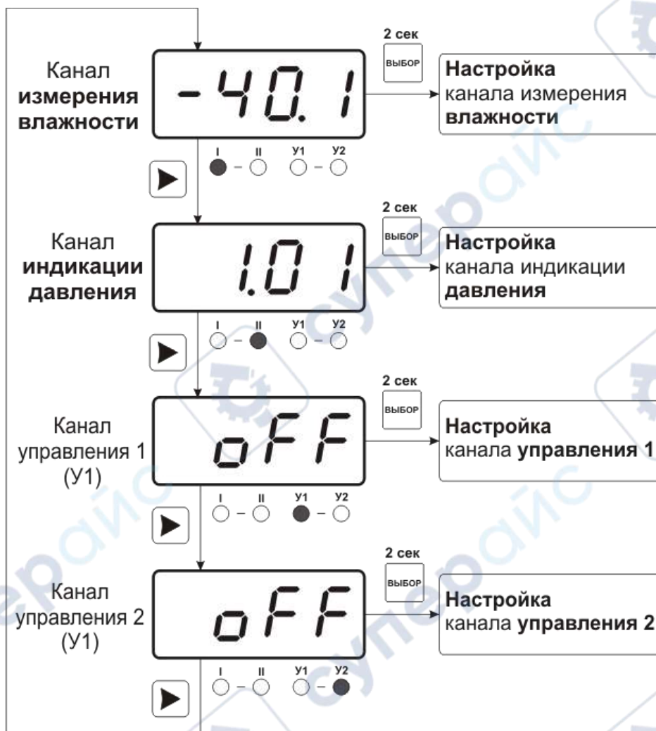
Рисунок 6.1 Схема режимов “РАБОТА” и “НАСТРОЙКА”
