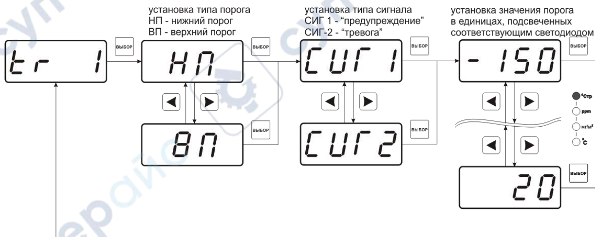
Рисунок 6.5 Схема задания порогов по температуре (влажности, давлению)
