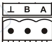
Рисунок 3.6 Вид разъема RS-485
