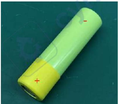
3 安装电池时，请确保电池正极有绝缘管，否则请参考以下步骤安装绝缘热缩管。
