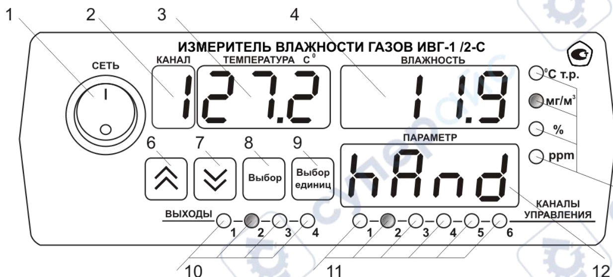
Рисунок 3.1 Вид лицевой панели прибора: ИВГ-1 /1-С-2А, ИВГ-1 /1-С-4Р-2А, ИВГ-1 /2-С-4Р-2А (сверху вниз).
