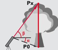
Направьте лазер на верхние точки и отслеживание угла/высоты начнется автоматически.
