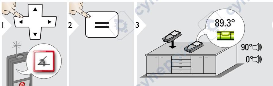
**i** Отклонение отображается постоянно. Прибор подает сигнал при углах 0° и 90°. Идеально подходит для регулировки горизонтали или вертикали.
