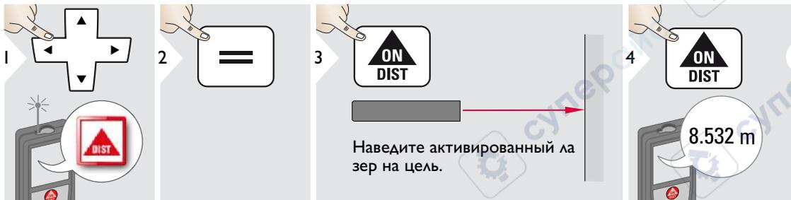
**i** Целевые поверхности: Ошибки при измерениях могут возникнуть в случае выполнения измерений до таких поверхностей, как бесцветные жидкости, стекло, стирфом, матовые полупрозрачные поверхности или при наведении на очень блестящие поверхности. При наведении на темные поверхности время измерения увеличивается.
