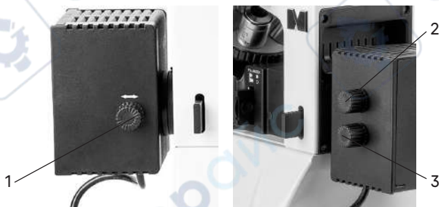
Рис. 8. Центрировка источника света
