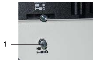
Рис. 5. Переключение канала визуализации
