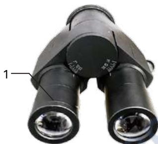
Рис. 7. Регулировка диоптрийной системы
