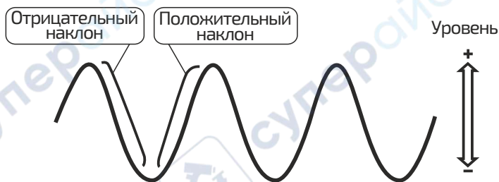
Рисунок 6. Иллюстрация полярности (фронтов) запуска синхронизации.
