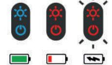
После снятия и установки аккумулятора – прибор не будет включаться, даже с полностью заряженным аккумулятором пока не будет проведена его инициализация. Для этого подключите зарядное устройство к порту USB прибора, когда кнопка включения начнёт мигать красным цветом, включите прибор. После включения на дисплее будет отображаться зарядка аккумулятора. Зарядное устройство можно отключить и пользоваться в обычном режиме.
