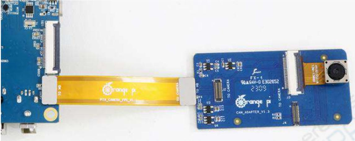
摄像头插在开发板的 Cam3 接口的方法如下所示：
