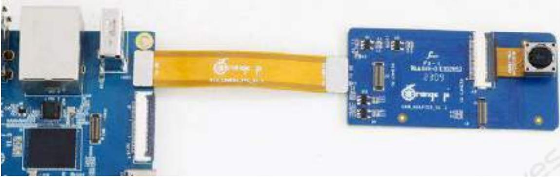
安卓系统默认打开的是 **Cam1** 和 **Cam3** 的配置，所以如果要使用摄像头，请选择 **Cam1** 和 **Cam3** 接口中的一个。连接好摄像头到开发板上后，我们可以使用下面的方法来测试下摄像头：
