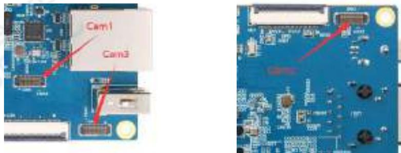
摄像头插在开发板的 Cam1 接口的的方法如下所示：
