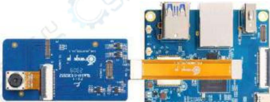
摄像头插在开发板的 Cam2 接口的方法如下所示：
