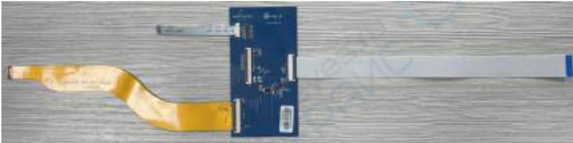
3) 按照下图将连接好排线的转接板置于 MIPI LCD 屏上面，并通过 31pin 转 40pin 排线连接 MIPI LCD 屏与转接板
