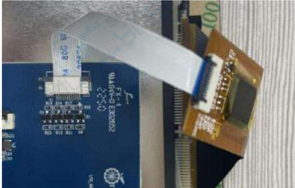
5) 最后通过 30pin MIPI 排线连接到开发板的 LCD 接口上
