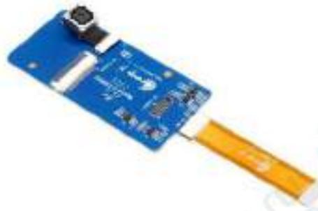
OV13850 和OV13855 摄像头使用的转接板和FPC排线是一样的，只是两款摄像头接在转接板上的位置不一样。FPC排线如下图所示，请注意FPC排线是有方向的，标注**TO MB**那端需要插到开发板的摄像头接口中，标注**TO CAMERA**那端需要插到摄像头转接板上。
