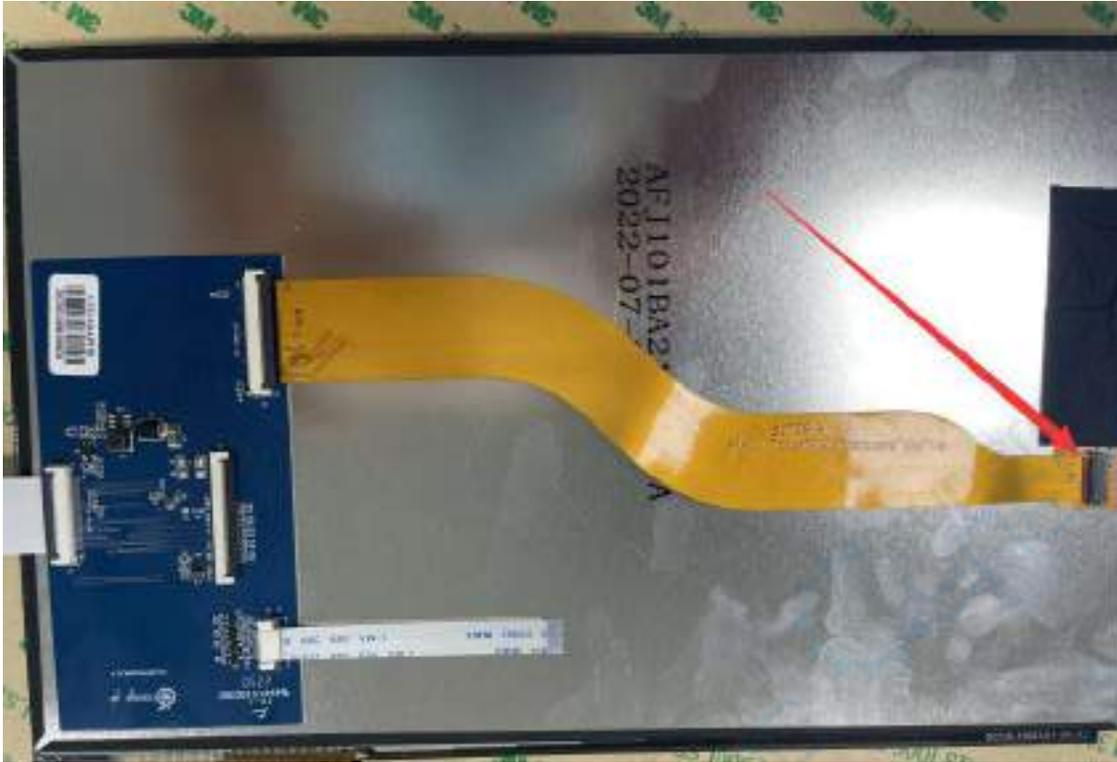
4) 然后通过 12pin 触摸屏排线连接触摸屏与转接板，注意绝缘面的朝向
