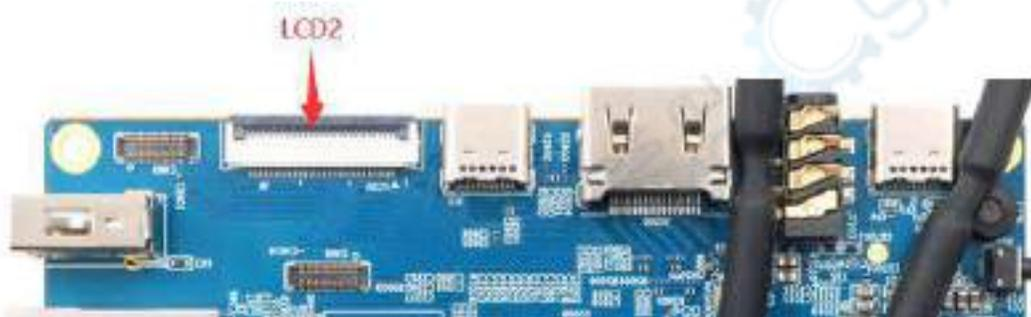
3) 将组装好的屏幕接到 lcd1 或者 lcd2 接口，给板子接通 Type-C 电源，并上电，系统启动后，就可以看到屏幕显示如下图所示
