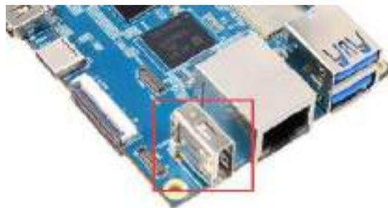
3) 然后通过 Type-C 数据线连接好开发板与 Ubuntu PC，开发板 Type-C 接口的位置如下图所示：
