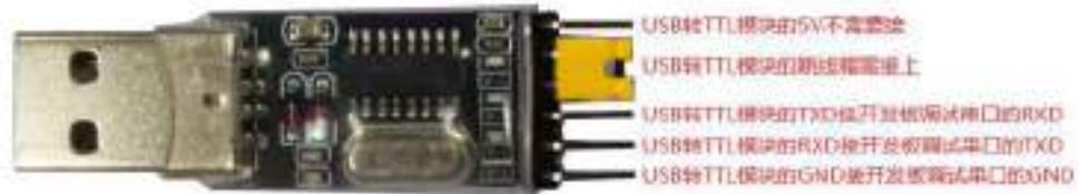
2) 开发板的调试串口 GND、RXD 和 TXD 引脚的对应关系如下图所示
