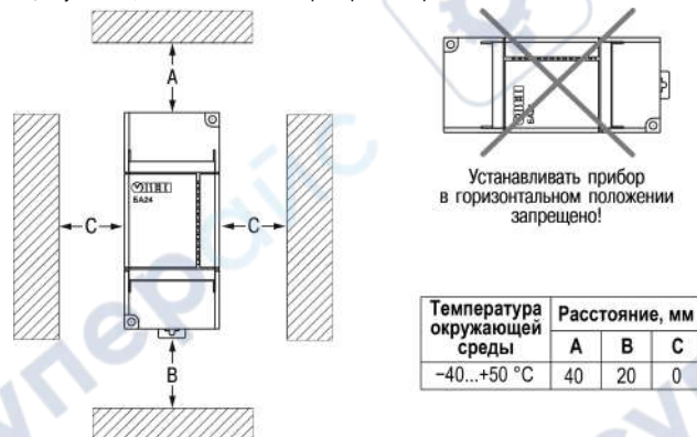
Рисунок 4.1 – Рекомендации по размещению прибора
