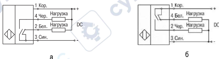
Рисунок 20 - Схема подключения четырехпроводных NO+NC – датчиков а – NPN типа, б – PNP типа
