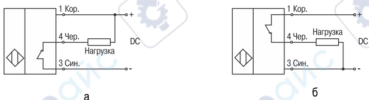
Рисунок 19 - Схема подключения трехпроводных NC – датчиков а – NPN типа, б – PNP типа
