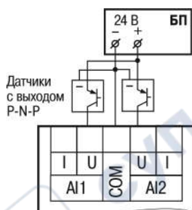
Рисунок 5.7 – Схема подключения к универсальным входам, работающим в дискретном режиме трехпроводных дискретных датчиков, имеющих выходной транзистор р-п-р-типа с открытым коллектором
